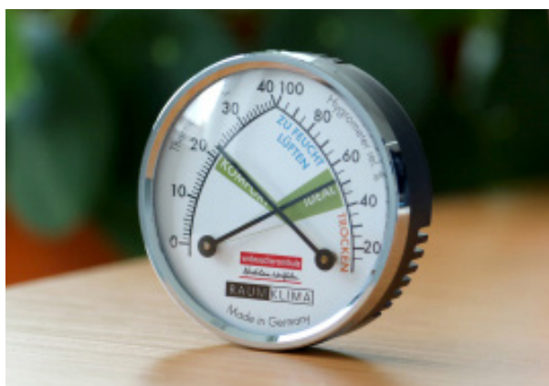
Ein Thermo-Hygrometer zeigt die relative Luftfeuchtigkeit und die Raumtemperatur an.
